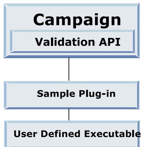
L'exécutable peut être écrit dans n'importe quel langage, mais il doit se trouver et être exécuté sur le serveur IBM Campaign. Le plug-in qui appelle l'exécutable envoie un fichier XML qui contient les informations à valider (par exemple, l'utilisateur éditant l'objet ainsi que les valeurs précédentes et suivantes de tous les attributs standard et étendus de cet objet). IBM Campaign attend en retour un résultat sous la forme d'un fichier XML.
